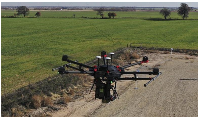
Figura 8.6: Ricerca di perdite con il drone
