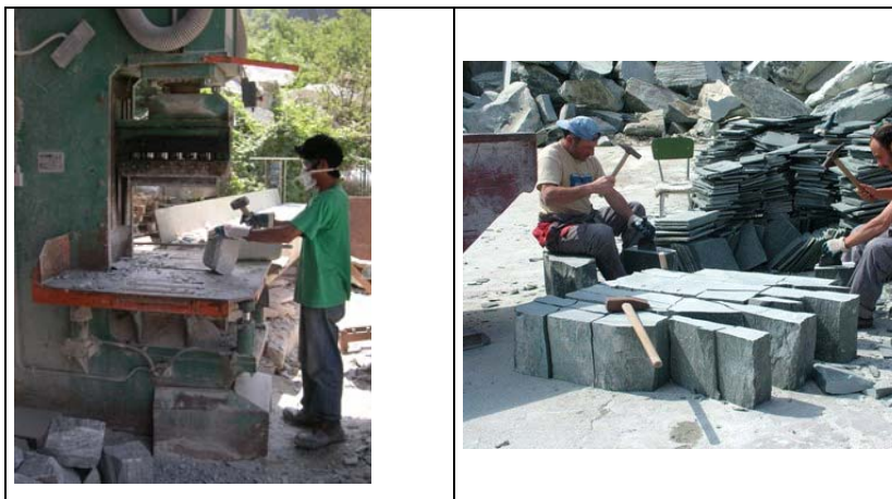
Fig.1-2: : Pavimentazioni: cubettatura a macchina e scalpellatura a mano
