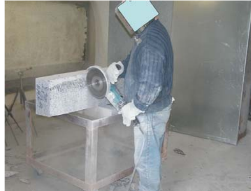
Fig.1: Finitura manuale con fresatrici a disco
