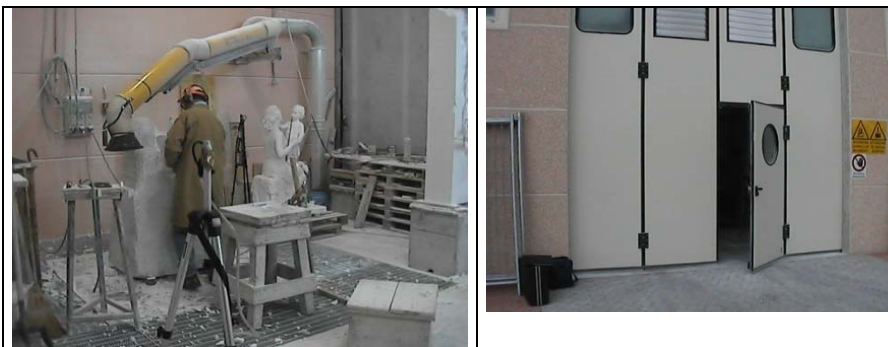
Fig.5-6: Cappe aspiranti orientabili (3) e griglia a pavimento (4)
