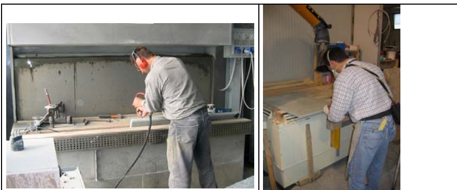
Fig.7-8: Banco aspirato con parete ad acqua o con proboscide (5)
