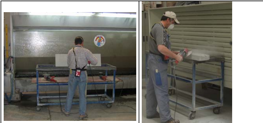
Fig.3-4: Parete ad acqua (1) e parete multifessura aspirati (2)
