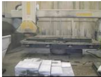
Fig.1: Taglio lastre con segatrici (fresse) a ponte ed a bandiera
