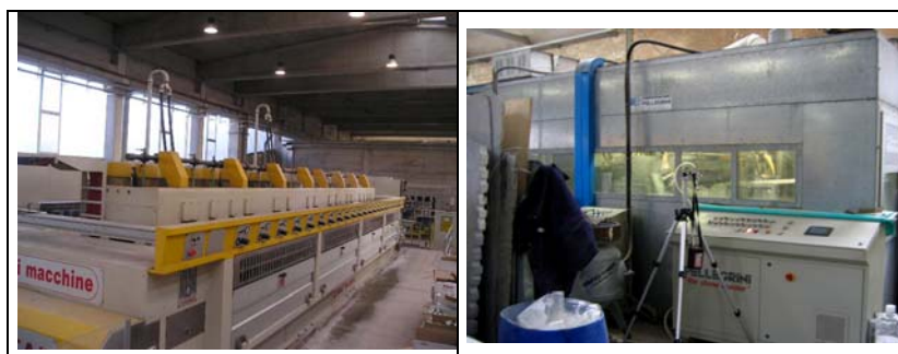
Fig. 1: Linee di trattamento superficiale a nastro e bocciardatrice
