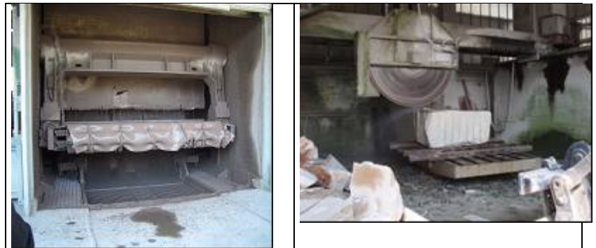
Fig.1: Taglio blocchi con telai multilame e con tagliatrici a disco
