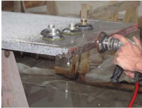
Fig.2: Finitura manuale con smerigliatrici e lucidatrici ad acqua
