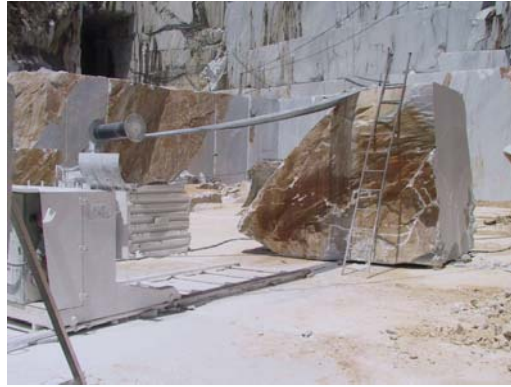
Fig.1: Abbattimento con tagliatrici a filo diamantato
