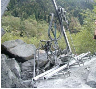
Fig.16-17: Perforatrice automatica cabinata con abbattimento sia ad acqua che ad aria (particolari)
