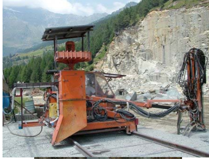
Fig.16-17: Perforatrice automatica cabinata con abbattimento sia ad acqua che ad aria (particolari)
