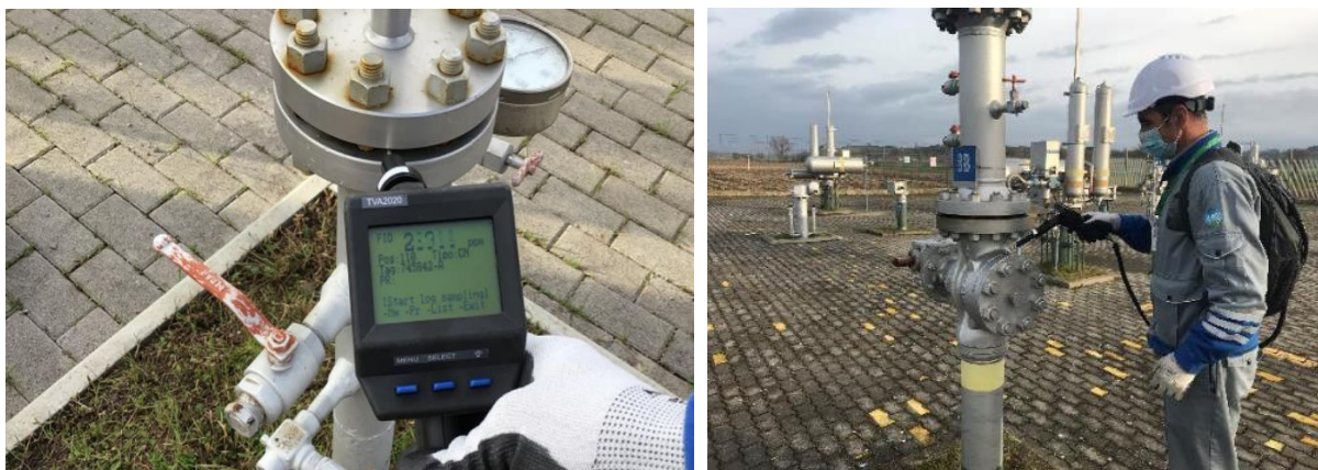
Figura 9.4: Effettuazione campagna LDAR mediante FID
