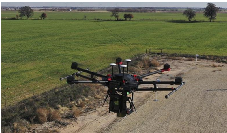
Figura 8.6: Ricerca di perdite con il drone
