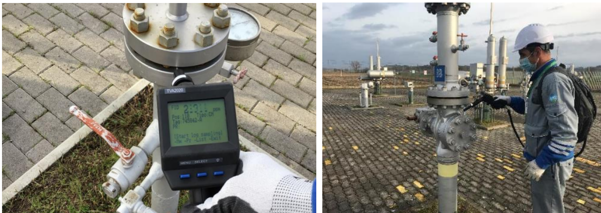
Figura 9.4: Effettuazione campagna LDAR mediante FID
