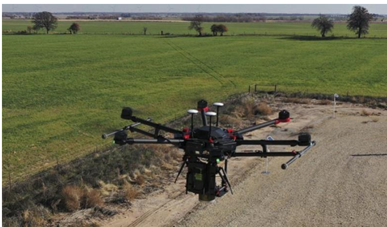
Figura 8.6: Ricerca di perdite con il drone
